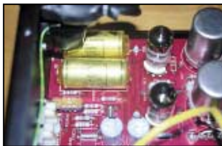
Condensatori in carta e olio e due doppi triodi 6922 per un suono molto piacevole.
