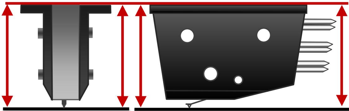
**TOP SURFACE OF CARTRIDGE BODY SHOULD BE PARALLEL WITH RECORD SURFACE, WHEN VIEWED FROM THE FRONT AND SIDE.**
