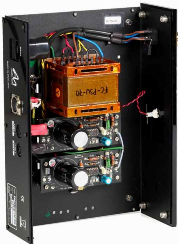
Zur AN-E gehören ein Speiseteil (links) sowie eine externe Frequenzweiche (unten). Die offenen Gehäuse geben einen Einblick in die finessierte Auswahl von „Klangmaterialien“, die bei den Briten Tradition hat: selbst gegossene Transformatoren, gedämmte Kondensatoren, eine isolierende Holzplatte unter der Weiche – nichts wird hier dem Zufall überlassen.
