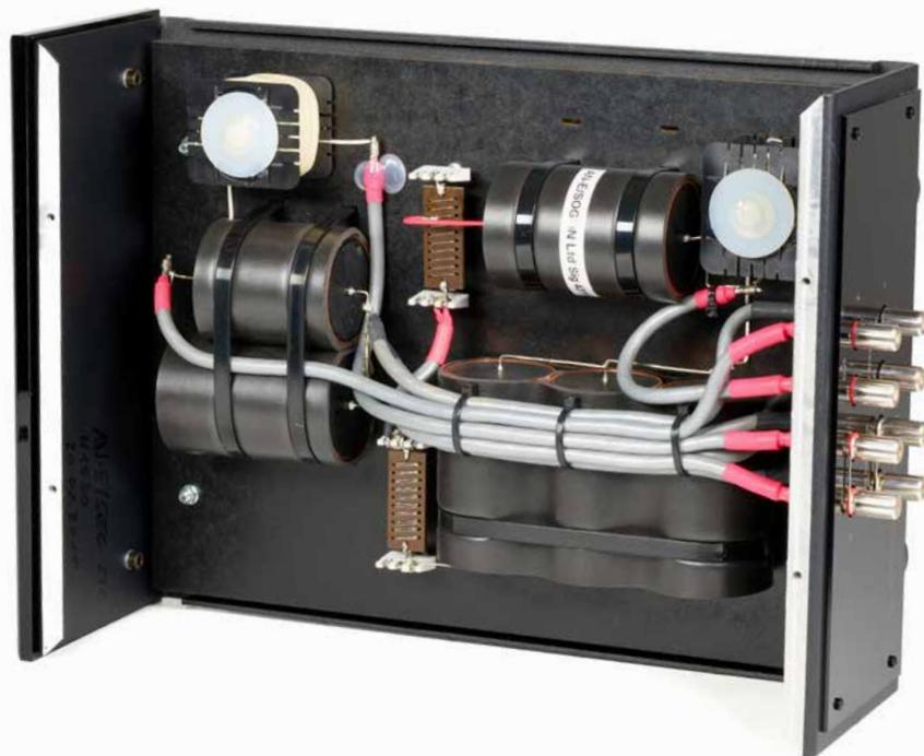
eigene Komponenten und Zutaten. Von den Transformatoren über die Kondensatoren bis hin zu den Spulen entstehen alle Elemente einer AN-E Ltd vor Ort in Partridge Green. Ehrensache, dass die Entwickler bei ihrem Top-Lautsprecher nur zu den erlesensten Bauteilen inklusive der Reinsilberverdrahtung des großen AN-E-Serienmodells (SPx) griffen. Denken Sie aber bloß nicht, dass einfach das Teuerste von allem in die Kisten geschraubt wurde.
