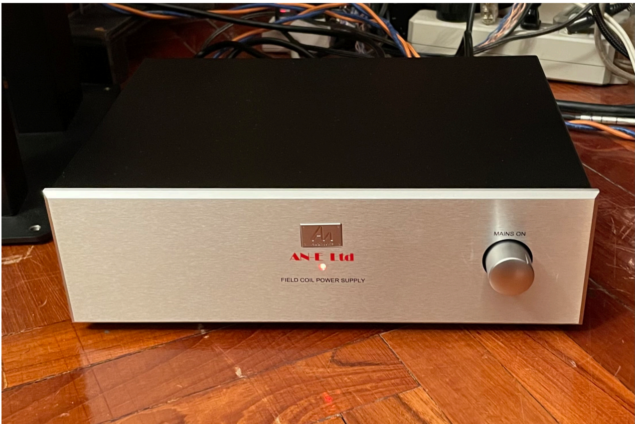
AUDIO NOTE AN-E-Ltd 外置原廠製作的直流供電器。
